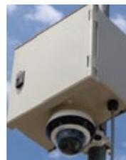
可動域330°、16倍ズーム機能にて広範囲の撮影ができ、遠隔操作にて角度の調整が可能です。赤外線カメラにて最大20mまで夜間や暗所、雨の日でも撮影します。
